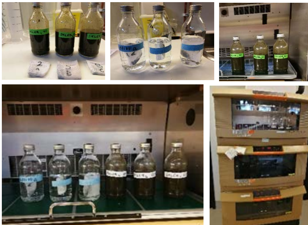
Figur 4. A) Flasker med digestat og poser med sklerotier. B) Flasker med vann og poser med sklerotier. C) Flasker og sklerotier i 41 °C ovn. D) Sklerotier i vann (kontroll) og i digestat i 55 °C ovn. E) inkubatorskap brukt i forsøket.
